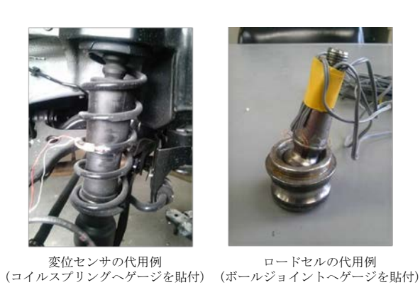
図5 トランスデューサの適用例
