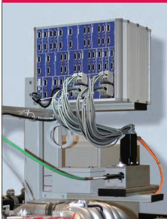
imc CANSASはCANバスへ接続する計測/制御モジュールです。パレットと組み合わせた計測器の効率的な運用を提案し、エンジンベンチの稼働率向上に貢献します。
