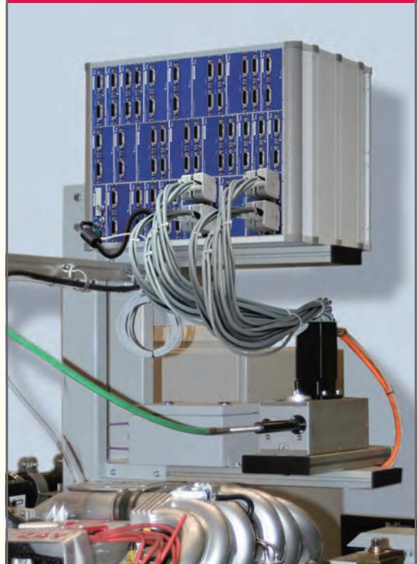
imc CANSASはCANバスへ接続する計測/制御モジュールです。パレットと組み合わせた計測器の効率的な運用を提案し、エンジンベンチの稼働率向上に貢献します。
